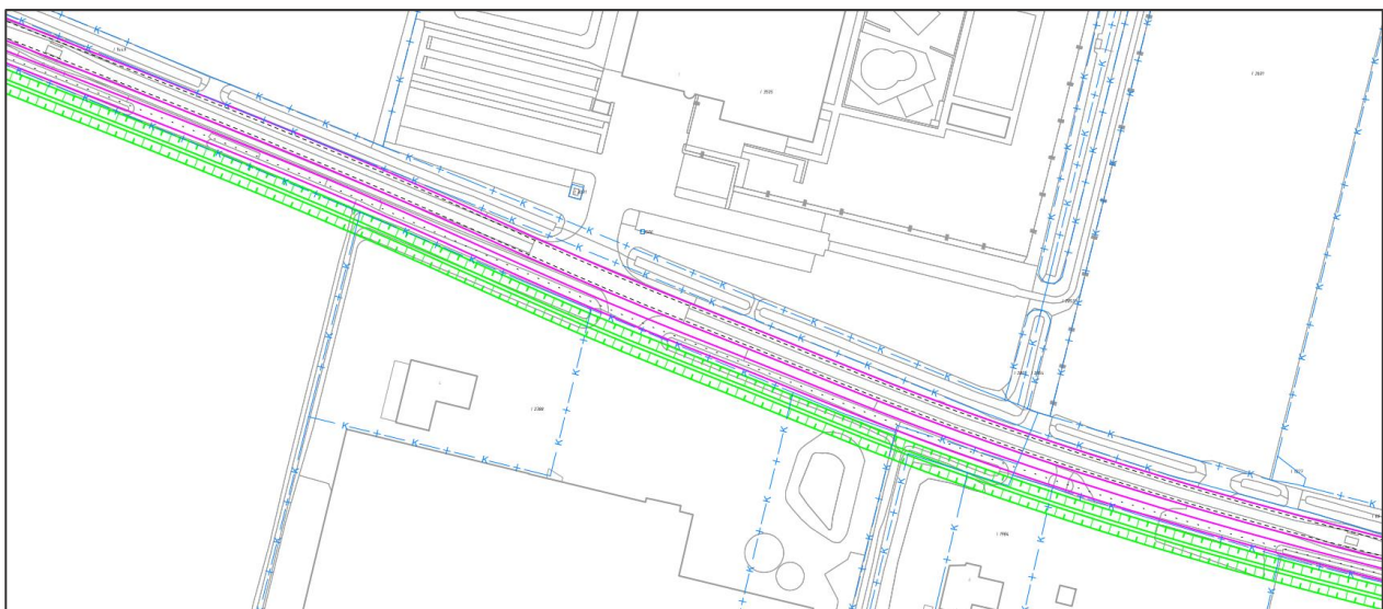
Figuur 15 Ruimtebeslag vrijliggend tweerichtingen fietspad zuidzijde
