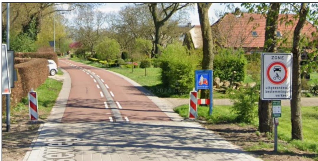
Figuur 24 Voorbeeld fietsstraat buiten bebouwde kom – Steenenkamerseweg in de gemeente Putten. Door een verbod op auto- en motorverkeer is de hoeveelheid gemotoriseerd verkeer laag. Dit is een voorwaarde voor een geloofwaardige fietsstraat.
